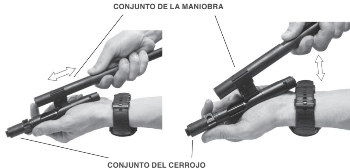
3. Comience a poner el conjunto de la Varilla de maniobra con el conjunto del arma. Gire el cerrojo hasta que las orejas de fijación se alineen con los rieles del Puente de receptor. Empuje hasta que las orejas de fijación asienten en los rieles.
