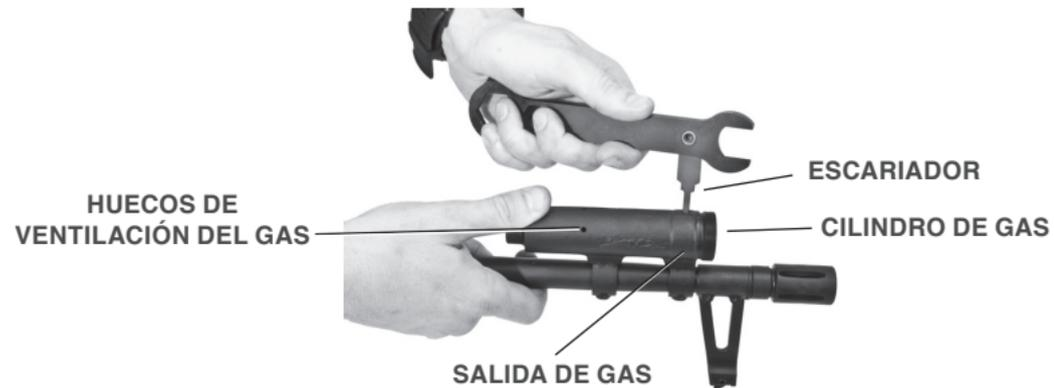
**PRECAUCION:** NO deje que entre lubricante en el sistema de gas. Para mantener el sistema seco, mantenga el cañón al revés con el punto de mira y el mango portador hacia abajo mientras limpia el ánima.
