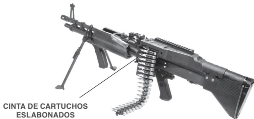
3. Jale la palanca de amartillar completamente hacia atrás y sujétela. Ponga la palanca selectora en posición “S” seguro y retire la cinta de cartuchos eslabonados.
