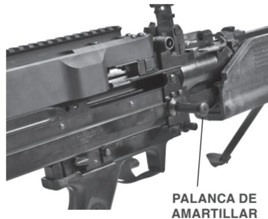
**ADVERTENCIA:** Si la tapa móvil es abierta (con un cartucho en la recámara,) situación de cañón caliente, un autodisparo con la tapa móvil abierta podrá suceder, causando lesiones graves o la MUERTE. Si tiene un cartucho en la recámara con una situación de cañón caliente, evacúe el área durante 15 minutos. Una vez transcurrido este tiempo ejecute la ACCION INMEDIATA correspondiente (ver la página 30).
