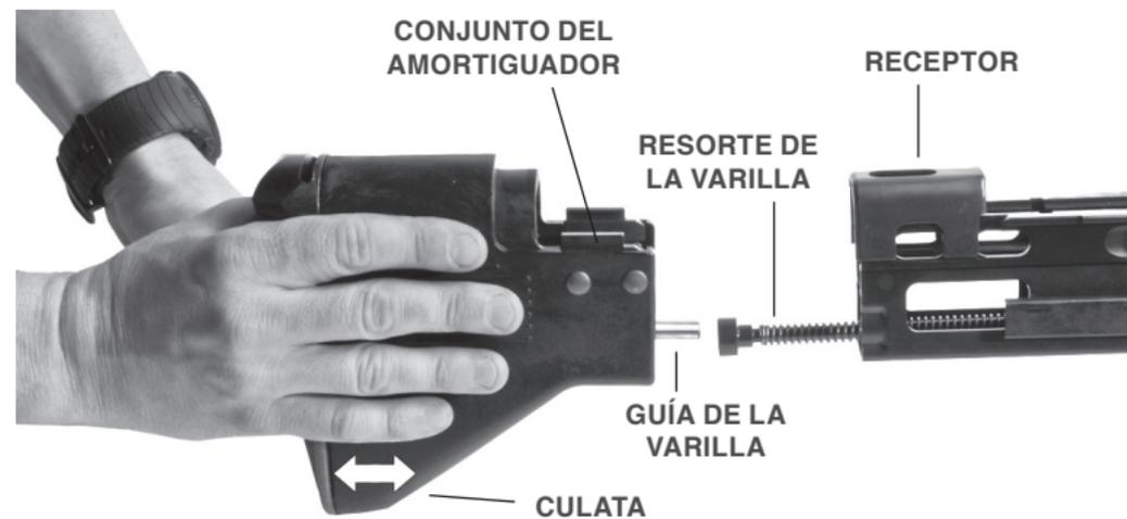
10. Quite el conjunto del amortiguador de la culata en al forma indicada en el dibujo.
